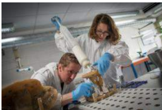
Slika 3 - Ispunjavanje kalupa od silikona pri izradi modela
